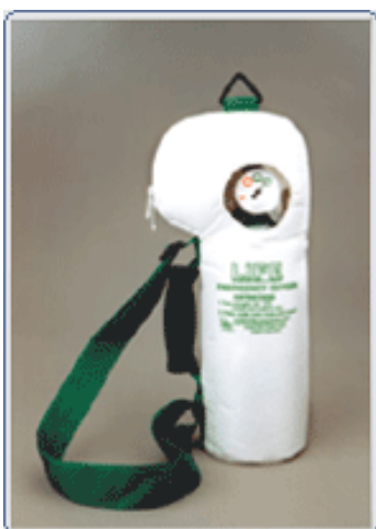
Lehký mobilní zdroj kyslíku 2,7 kg, rezerva při 6 l/min na 40 minut, průtok 6 - 12 l/min, molitanový obal, pro použití s laickou maskou
