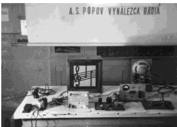
Obr. 4 Napájací zdroj a superreakčný prijímač na VKV pásma postavené B. Dubravcom.
