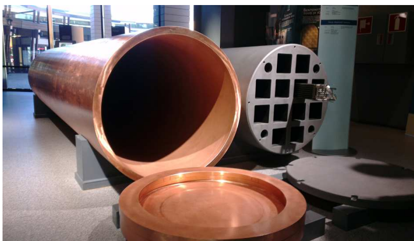
Obr. 12: Obalová kazeta pro uložení VJP ve Finsku v úložišti Olkiluoto (foto: doc. J. Knápek)
