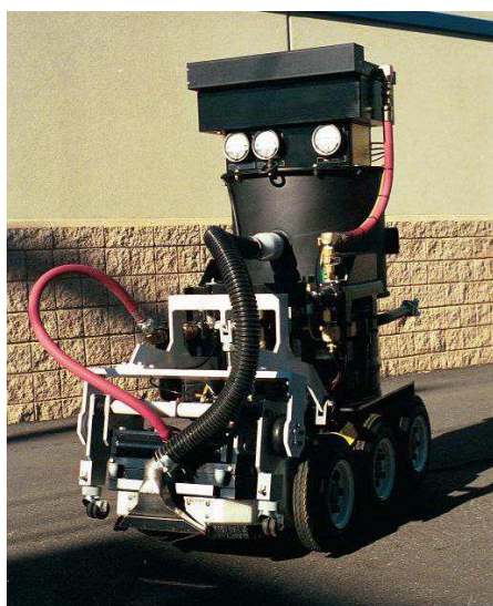
Obr. 5: Dekontaminační bruska na beton PENTEK ( http://www.pentekusa.com/ )
