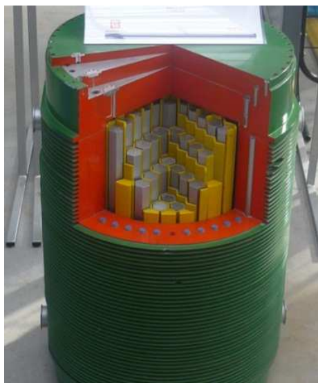
Obr. 14: Skladovací kontejner CASTOR ( http://www.spstrplz.cz/ )
