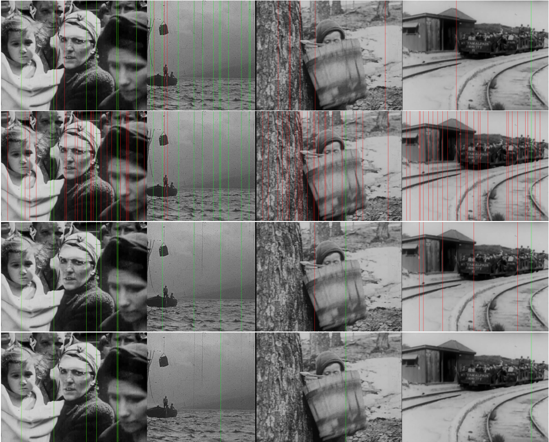
Obr. 6.7 – Detekce vertikálních škrábanců prostorovými detektory. Seshora dolů detektory Bruni, Wav140, Wav170, Wav200. Zleva doprava snímky WAR130, SITDOWN, MAPLE50, MOUNT60. Červeně jsou vyznačeny falešné detekce, zeleně správně detekované škrábance.
