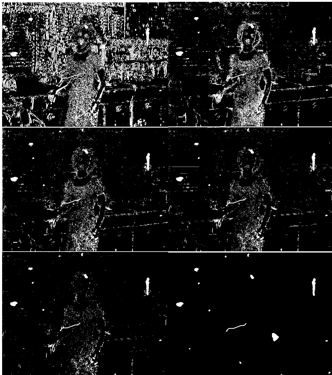
Obr. 5.8 – Detekce skvrn jednotlivými detektory ve snímku 14 sekvence ROD2 při T1=8 . První řada vlevo: Storey; První řada vpravo: SDIa; Druhá řada vlevo: SDIp; Druhá řada vpravo: ROD; Třetí řada vlevo: sROD; Třetí řada vpravo: reálná mapa uměle vytvořených skvrn
