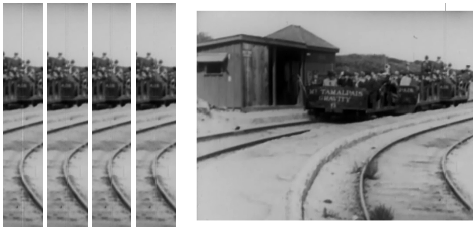
Obr. 6.17 – Vlevo: část snímku MOUNT60 s detekovaným světlým škrábancem. První je originální bez rekonstrukce, následující jsou rekonstruované s poloměrem nastaveným postupně na 1, 2 a 3 pixely. Vpravo: Snímek MOUNT60 rekonstruovaný s poloměrem nastaveným na 1 pixel.
