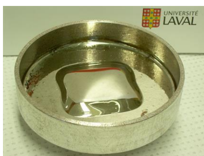
Obrázok 2.4: Povrch ferokvapaliny s vyššou reflexivitou [14]
