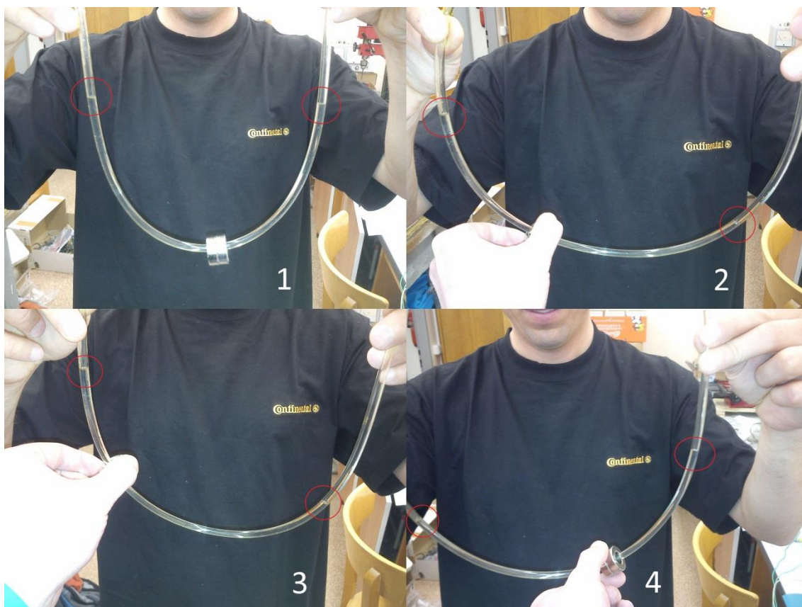
Obrázok 4.1: Overenie funkčnosti magnetického pola a ferokvapaliny na transformátorový olej, červenou sú označené hladiny oleja
