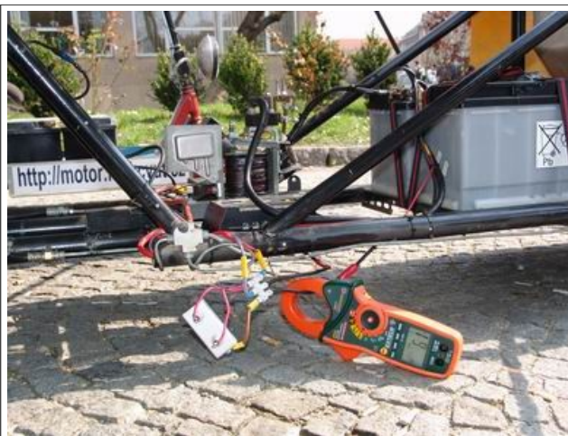
Ano, je to tak – solární články opravdu pracují a dobíjí akumulátory proudem 6,1A.
